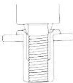
4. Вставьте заклепочный пистолет в отверстие: Просверлите в заготовке отверстие: его размер должен быть на 0,1 мм больше внешнего диаметра гайки.
