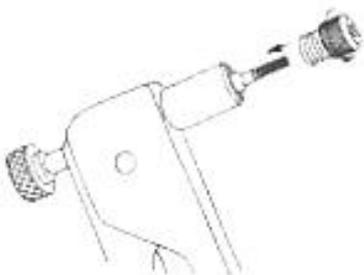
2. Сведите ручки и вверните подходящую насадку против часовой стрелки в оправку.
