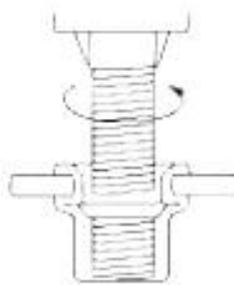
6. Вытащите часть гайки из отверстия: используйте ручку инструмента, чтобы отвинтить и вытащить часть гайки из отверстия.
