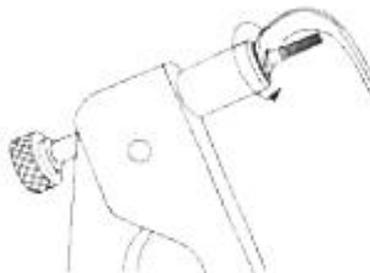
1. Открыв ручки, прикрутите оправку с резьбой против часовой стрелки к заклепочному пистолету с помощью гаечного ключа.
