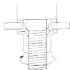
5. Расширьте гайку: плотно сожмите две ручки, гайка расширится и зафиксируется в отверстии.
